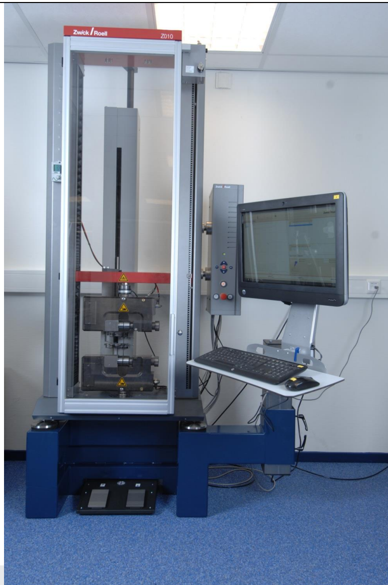
Foto: Trekbank (o.a. apparatuur voor bepalen afpelsterkte lasverbindingen)
